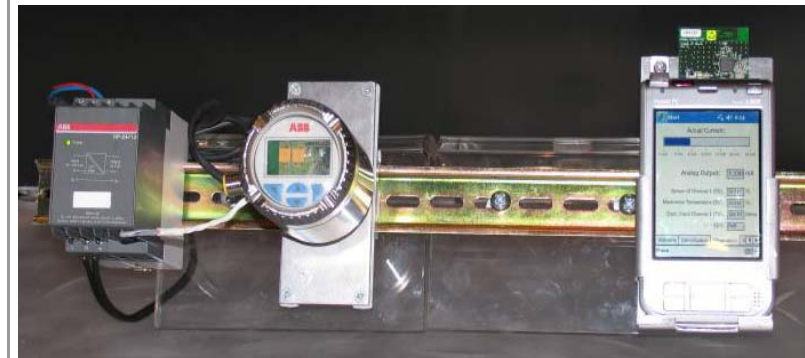
Zigbee Point - Point HMI Zigbee 技术的点对点人机界面
